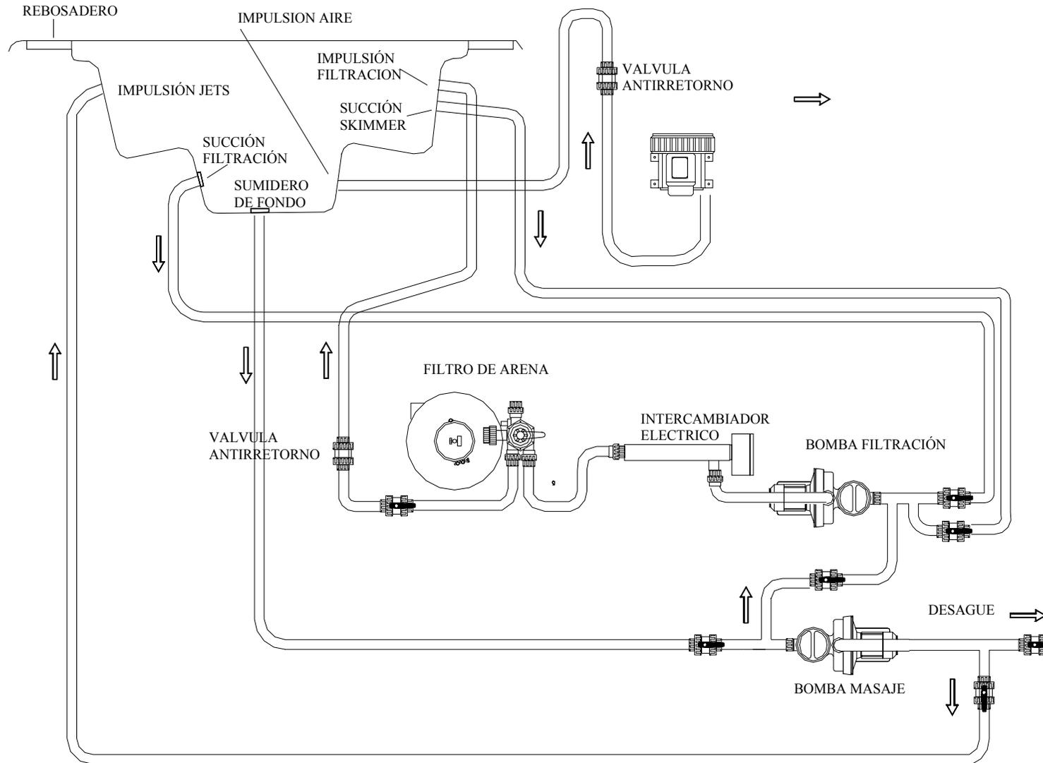
Esquemas de conexiones hidráulicas del circuito de filtración con intercambiador de placas
