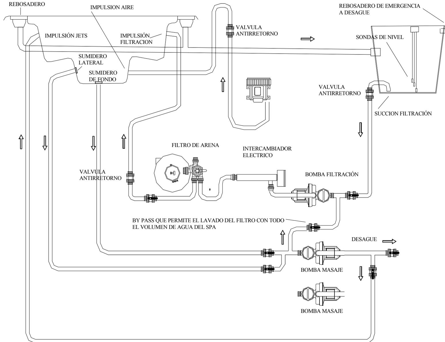
Esquemas de conexiones hidráulicas del circuito de filtración con intercambiador de placas
