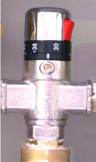
La temperatura del agua caliente de la ducha se regula a través de la válvula termostática situada en el cuadro de válvulas, para regular girar el mando hasta hacer coincidir la temperatura deseada, con la línea de referencia. Como seguridad, para sobrepasar los 35 grados de regulación hay que presionar el botón rojo y hacer girar el mando al mismo tiempo.
