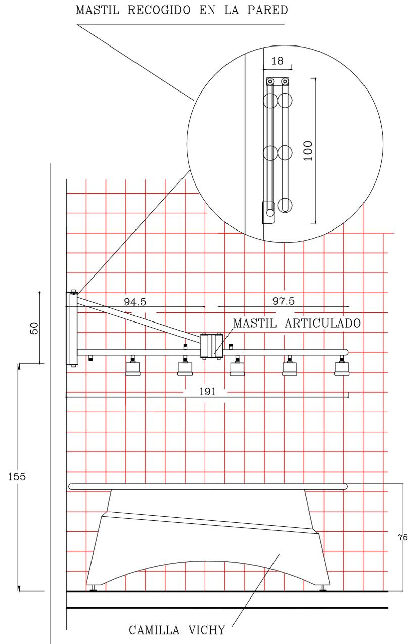
**SISTEMA CONSTRUCTIVO DEL EQUIPO HIDRAULICO**
